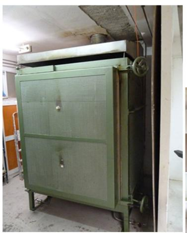
600,-€ liefern. Das Brennofengestell ist für die Steinmaße 250x124 mm bemessen, der Innenausbau ist sehr einfach und unkompliziert auszuführen. Beratung ist zugesichert. Der Brennofen eignete sich hervorragend für Reduktionsbrände und wurde bis 1270° gebrannt. Insgesamt könnt Ihr Euch mit dem Angebot einen Kammerbrennofen mit neuer Ausmauerung1,3 m ³ für 5.700,-€ zulegen.
